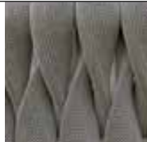
fissage en tube autour d'une âme en caoutchouc material wrapped around a rubber core tejido en tubo alrededor de un alma de caucho
