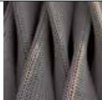
tissage en tube autour d'une âme en caoutchouc material wrapped around a rubber core tejido en tubo alrededor de un alma de caucho
